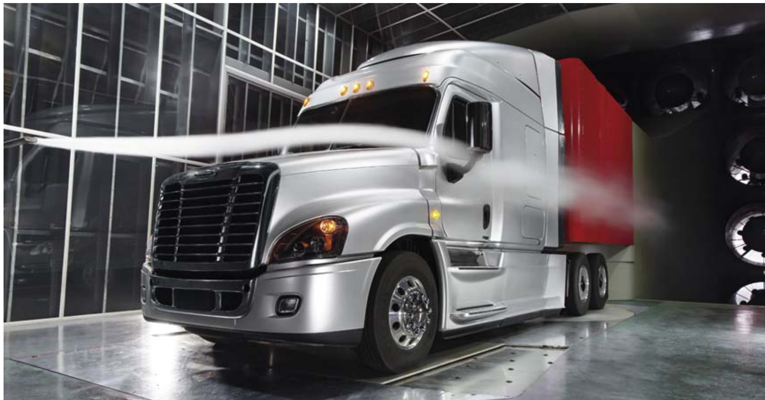
Der Freightliner Cascadia Evolution bietet Kraftstoffeinsparungen von 7% dank neuem Detroit DD15 Motor mit Daimler BLUETEC-Abgastechologie sowie aerodynamischen Maßnahmen.
